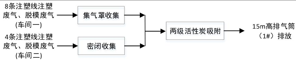
图 4-1 本项目废气处理工艺流程图
