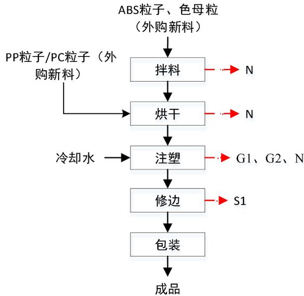
图 2-2 塑料制品生产工艺流程图
