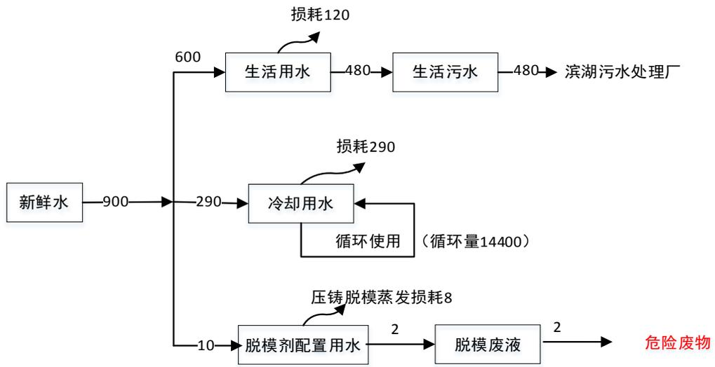
图 2-1 验收项目水平衡图 (t/a)
