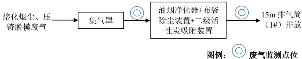
图 3-2 有组织废气处理流程图及监测点位
