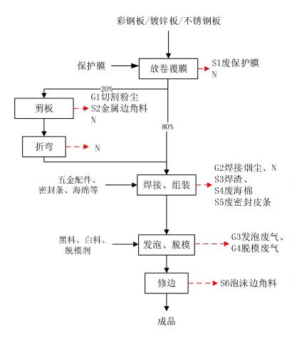
图 2-2 制冷配件生产工艺流程图
