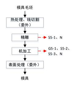
(注: Gn: 废气污染物; Sn: 固体废物; N: 噪声) 图 2-6 模具加工工艺流程图
