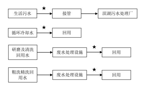
图 3-1 污水接管及监测点位图
