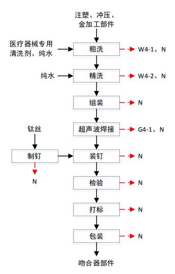
(注: Gn: 废气污染物; Wn: 废水污染物; Sn: 固体废物; N: 噪声) 图 2-5 吻合器部件工艺流程图
