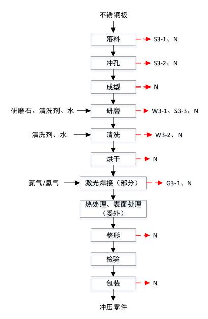
(注: Gn: 废气污染物; Wn: 废水污染物; Sn: 固体废物; N: 噪声) 图 2-4 冲压零件工艺流程图
