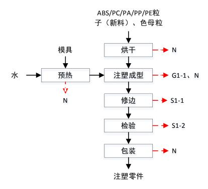
(注: Gn: 废气污染物; Sn: 固体废弃物; Nn: 噪声) 图 2-2 注塑零件工艺流程图
