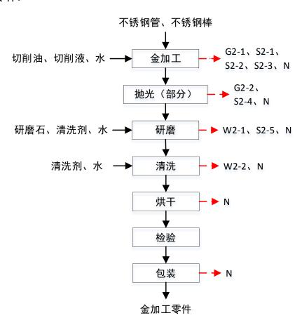
(注: Gn: 废气污染物; Wn: 废水污染物; Sn: 固体废物; N: 噪声) 图 2-3 金加工零件工艺流程图
