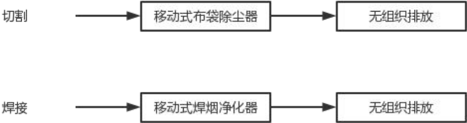
图 3-1 废气处理流程及监测点位图
