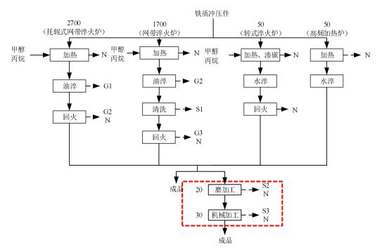
图 2-2 传动链条工艺流程及产污环节图
