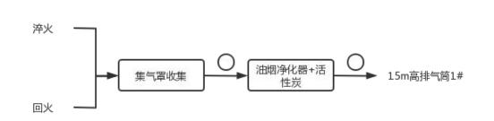
图 3-1 废气处理流程及监测点位图
